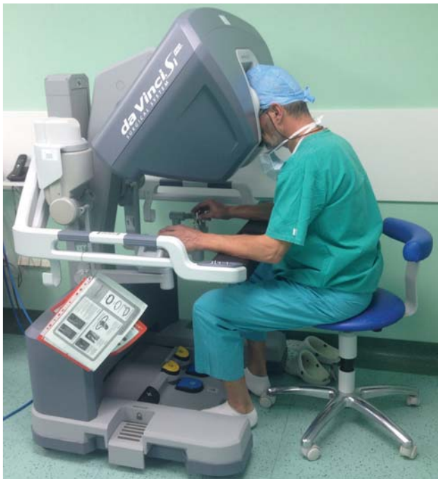
Obr. 19.18.2. Ovládací konzola robotického systému. Lékař – operátor sedí při ovládací konzole a na dálku ovládá distální části nástrojů prostřednictvím vysokocitlivých, na jednotlivých prstech navlečených joysticků. Obraz z kamery v operačním poli vidí pomocí stereoskopického zobrazovacího kanálu v 3D HD kvalitě na ovládací konzole. Pomocí nožných pedálů lékař ovládá koagulaci nástrojů, zaostření kamery a přepínání na další pracovní ramena.
