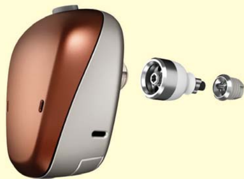
Obr. 19.1.109. Baha Connect®. V levé části obrázku je zvukový procesor, uprostřed abutment procházející kůží a vpravo implantát (zdroj: Cochlear, Sydney, Austrálie).
