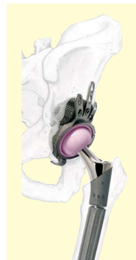
Obr. 18.18.26. Revízna modulárna totálna endoprotéza bedrového kĺbu. Modularita na strane acetabulárneho komponentu i femorálneho komponentu.
