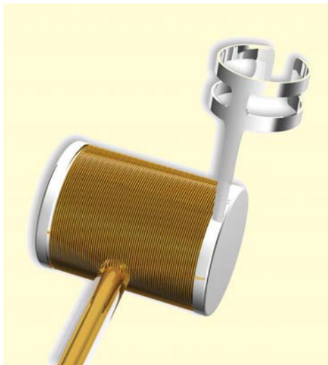
Obr. 19.1.112. Aktuator aktivního středoušního implantátu Vibrant SoundBride™ společnosti MED-EL. V tomto konkrétním případě se aktuator nazývá Floating Mass Transducer™ (FMT) a jde o miniaturní elektromagnet. Pomocí úchytky je připevněn na středoušní kůstky anebo je vsunut do okrouhlého okénka tak, aby byl v kontaktu s jeho membránou (zdroj: MED-EL, Innsbruck, Rakousko).
